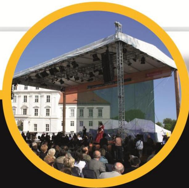
■ Die mobilen Überdachungen des Herstellers Contac Systems eignen sich gleichermaßen als Bühnenüberdachung, als auch als Sonnensegel welches in der Höhe zwischen 3 und 10 Meter motorisch verfahrbar ist. Bei Moonlight sind mehrere GS70, GS135, GS175 vorrätig. Darüber hinaus auch die Sonderhauten PD160 und RB2210.
